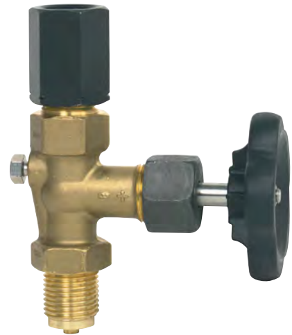
Запорный клапан согласно DIN 16270, регулировочная гайка с левой/правой резьбой/ наружная резьба G 1/2, PN 250
