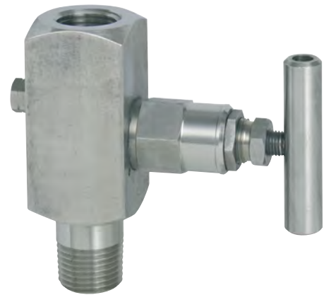
Цельнометаллический одиночный запорный клапан, внешняя/внутренняя резьба ½ NPT, PN 420, DN 5
